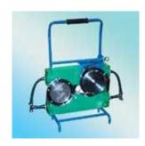
Прибор напорного фильтрования ПНФ-142-П рекомендуется для использования в полевых условиях. Принцип работы основан на мембранной фильтрации проб воды под давлением, создаваемым с помощью ножного насоса.
